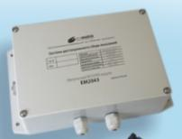
Внешний модуль для передачи по радио и/или каналу сотовой связи (GPRS) данных от счетчиков воды, газа и электроэнергии с импульсными выходами, а также от подключенного к модулю датчику давления. Модуль имеет 3 импульсных входа для подключения счетчиков, 1 аналоговый вход 0,4...2 (0...10) VDC для датчика давления, 3 дискретных входа реле уровня или подтопления, 1 вход сигнализации проникновения. Питание от встроенной литиевой батареи, срок автономной работы не менее 6 лет.
