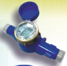
Счетчики EM-M - крыльчатые, многоструйные, холодной и горячей воды, с диаметрами условного прохода 15, 20, 25, 32, 40 и 50 мм. Счетчики предназначены для измерений, архивации и дистанционной передачи по радиоканалу объема питьевой воды в системах водоснабжения - холодного (при температуре от 0,1 до 50°C и давлении до 16 bar) и горячего (от 0,1 до 90°C и давлении до 16 bar). Счетчики имеют антимагнитную защиту, класс защиты IP68 и соответствуют метрологическому классу С.
