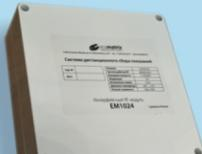
Внешний радиопередающий модуль для передачи данных с расходомеров и других устройств с радиоинтерфейсами RS232/485/CAN. Питание от сети 220 VAC. Модуль имеет встроенные интерфейсы RS232, RS485, CAN, а также 3 дискретных входа реле уровня или подтопления и 1 вход для подключения устройств сигнализации.
